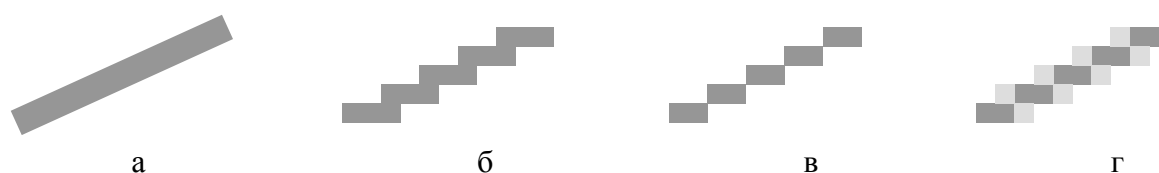
Рис. 21. а) Линия в векторном формате; б)—г) линия в растре, или разные способы дискретизации линии
