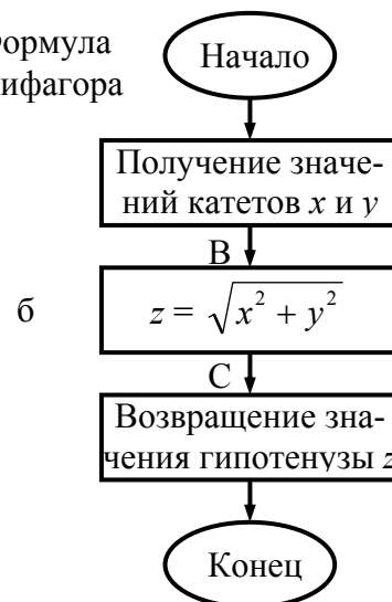
Рис. 29. Вычисление гипотенузы по катетам: а) главный алгоритм; б) функция
