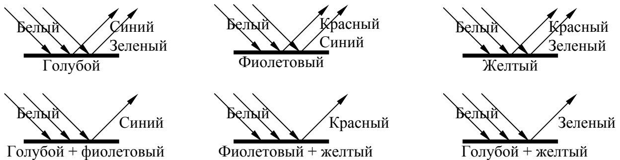
Рис. 8. Схематическое изображение отражения цвета от бумаги
